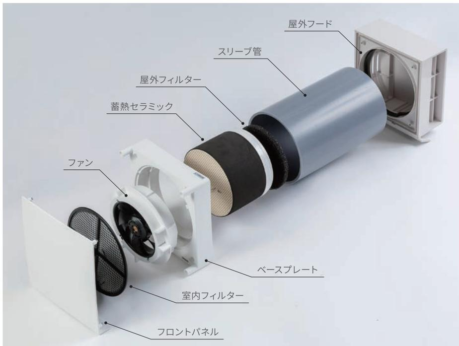
エアークーブは、熱を蓄える蓄熱セラミックを内蔵した熱交換型の換気システムです。熱交換性能は72~92%です。ファン本体は消費電力が少ない省電力設計の高性能DCモータータイプを採用しています。1セット当たりの風量は最大69 $\text{m}^3$ 、比消費電力は0.09(w/ $\text{m}^3$ /h)です。(キューハイフード使用時)
