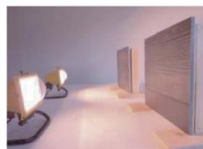
外壁表面温度が60℃になるようレフランプで照射後裏面の温度をサーモグラフィにて測定
