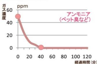
試験概要: 「床下さらさら」を入れた密閉容器にアンモニアガスを注入し経過時間ごとにガス濃度を測定し、除去能を算出する。
