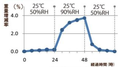
試験概要: 湿度変化にともなう「床下さらさら」の重量変化を試験装置により経時的に測定し、水蒸気の吸放湿量をもとめる。
