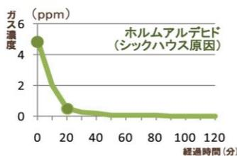
試験概要: 「床下さらさら」を入れた密閉容器にホルムアルデヒドガスを注入し経過時間ごとにガス濃度を測定し、除去能を算出する。
