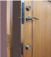
ダブル鎌錠 主錠、補助錠とも鎌錠を採用。 さらに補助錠は枠側もバック プレートで補強し、こじあけに 対する耐性が向上しました。
